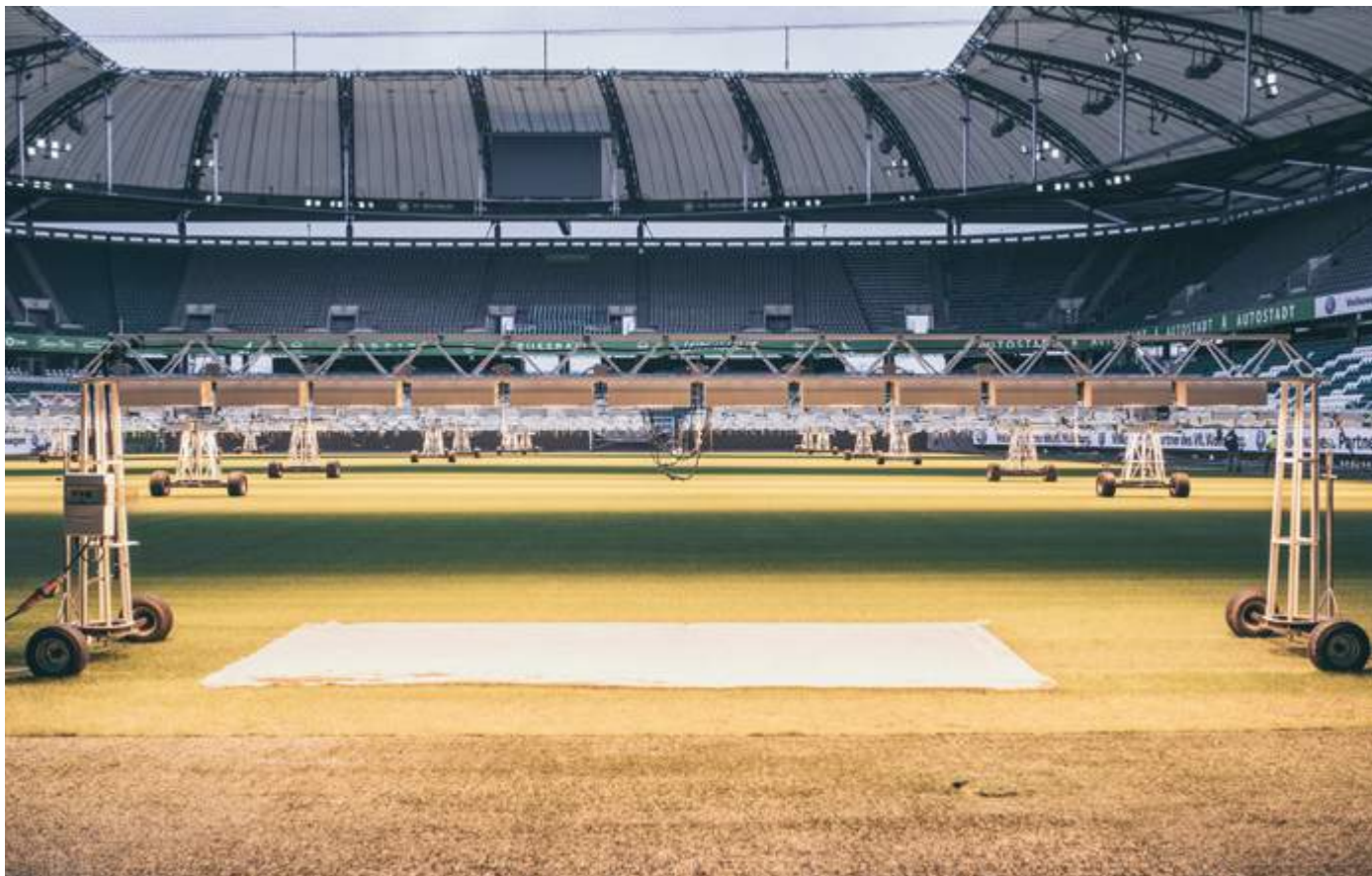
Da der Rasen in der Volkswagen Arena nicht genügend Sonne erhält, wird sein Bedarf mit künstlichem Licht gedeckt. Das erhält er von Lampen, die unter verschiebbaren Stahlkonstruktionen angebracht sind. Das goldgelbene Licht regt in dunklen Monaten das Wachstum der Graspflanzen an.
